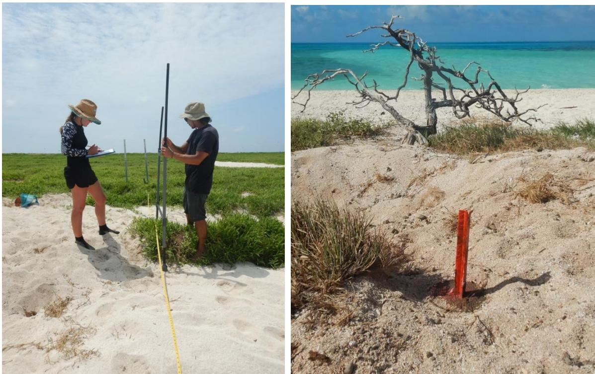
Figure 11 : A gauche : Réalisation d'un profil de plage avec le cadre Emery par les agents du SPNMCP ; A droite : Réimplantation d'une tête de profil - SPNMCP
