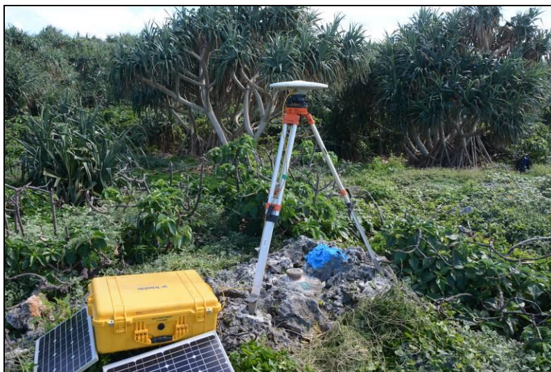
Figure 4. GPS haute précision installé par la DITTT à Walpole. Juin 2018.
